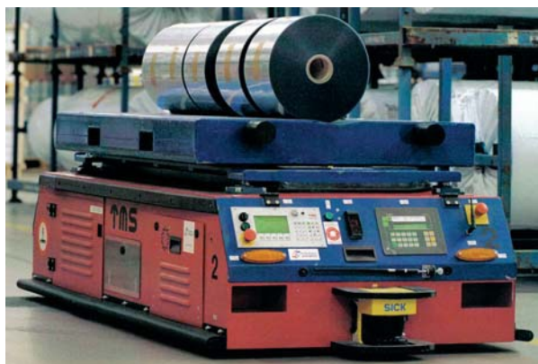
Fahrerloses Transportsystem in einer Druckerei
